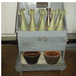
Otapanje TNT iz mine 120 mm
